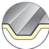
L'impiego di Tek 28 composto da uno strato di poliuretano ad alta densità porta a ridurre lo sbalzo termico nell'intercapedine della ventilazione e di conseguenza consente allo strato isolante di dare risultati nettamente superiori. Questo è un vantaggio significativo per creare un comfort abitativo migliore. In sostanza Tek28 permette di impedire significativamente la trasmissione del calore
