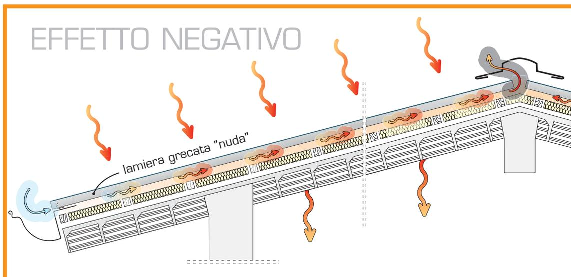
L'irraggiamento solare diretto su un elemento di lamiera nuda comporta un surriscaldamento dell'intercapedine di ventilazione, limitando i benefici del flusso d'aria all'intradosso della lastra, mantenendo elevate le temperature anche negli ambienti sottostanti.
