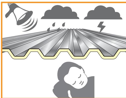
La copertura di un edificio costituisce una parte importante di quel perimetro dell'edificio da difendere e isolare dal rumore esterno. La particolare tecnologia produttiva alubel permette di **arricchire** i 5 o 6 decimi di metallo, di 10 mm di poliuretano espanso ad alta densità **perfettamente aderente**
