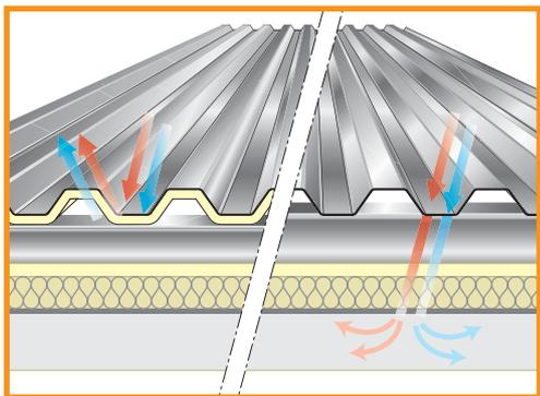
Nelle strutture metalliche è fondamentale isolare il manto di copertura dalla sottostante struttura metallica. L'impiego di Tek 28 con il suo strato protettivo che riveste all'intradosso la lamiera, riduce del 30% circa il carico termico che grava sulla superficie del pannello stesso e attenua notevolmente i ponti termici, costituendo una barriera alla dispersione del calore.
