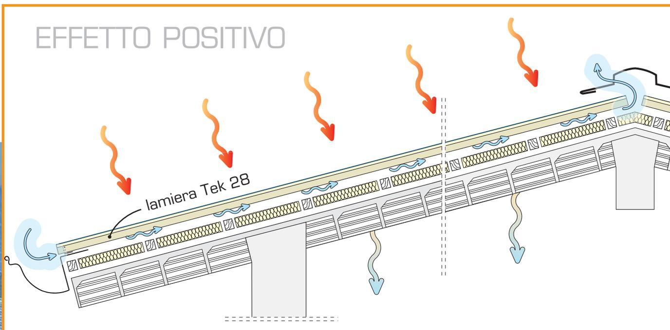
L'aria all'interno del pacchetto di copertura, utilizzando Tek 28, si mantiene "fresca" grazie allo strato costante di poliuretano che funge da "barriera". Il pacchetto di copertura nonché gli ambienti sottostanti godono di un comfort maggiore.
