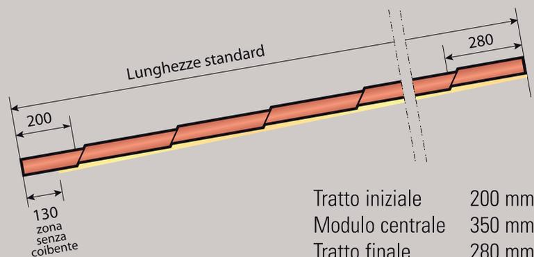
**Rossocoppo Basic** è un elemento modulare che viene prodotto in misure standard. Le lunghezze sono già predisposte per essere accoppiate fra loro in modo da coprire senza sfrido qualsiasi lunghezza di falda.
