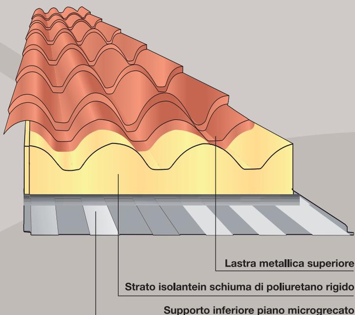
**Rossocoppo Plus** con la sua facilità di montaggio, con la sua estrema maneggevolezza e con le sue caratteristiche termoacustiche permette di abbattere notevolmente i costi di posa e di ridurre il consumo energetico.
