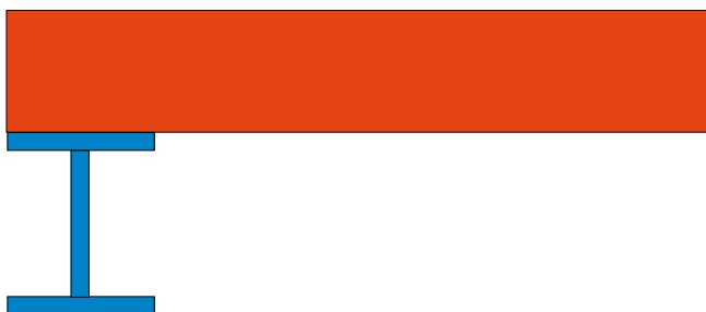
Valore U: 0,174 W/m 2 K Coibentazione: schiuma poliuretana, 14 cm
