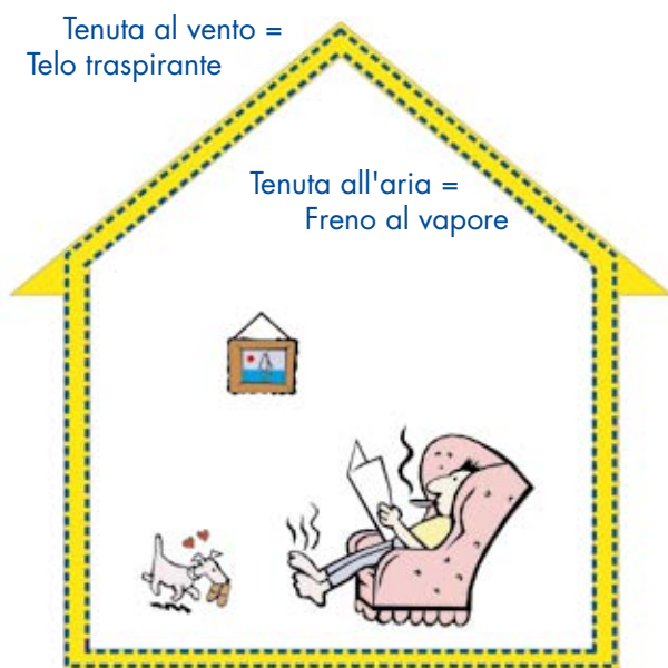
Fig. 1: Impermeabilità all'aria e diffusione al vapore
