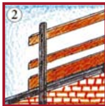
Solido ancoraggio montanti del parapetto
