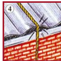
Punto con rischio taglio/rottura fune di collegamento
