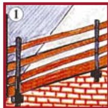
Solido ancoraggio montanti del parapetto
